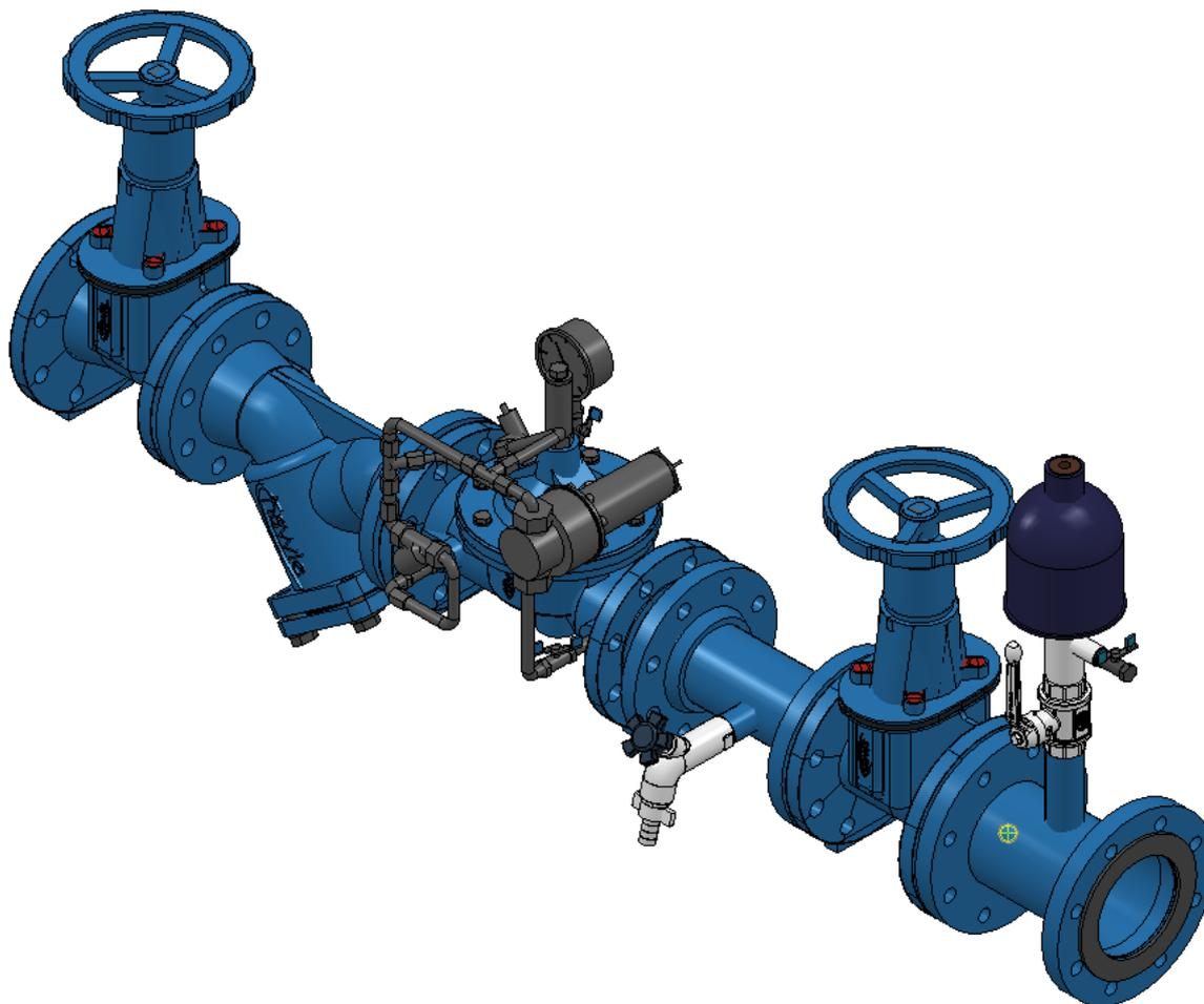
La HAWIDO deve essere installata orizzontalmente (altri sistemi di costruzione su richiesta) con il coperchio della valvola verso l'alto. Consigliamo di montare una saracinesca ed un filtro sul lato d'entrata ed una saracinesca sull'uscita. Utilizzando la HAWIDO 1400 come valvola di sicurezza, è possibile rinunciare alla saracinesca sul lato di uscita. Prima della messa in servizio è necessario verificare che nessun corpo estraneo grosso possa infilarsi nella HAWIDO.
