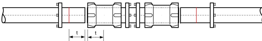
4. Repoussez le connecteur jusqu'à la profondeur d'insertion marquée (Attention : si le tuyau existant est trop large, une force plus importante peut être nécessaire)
