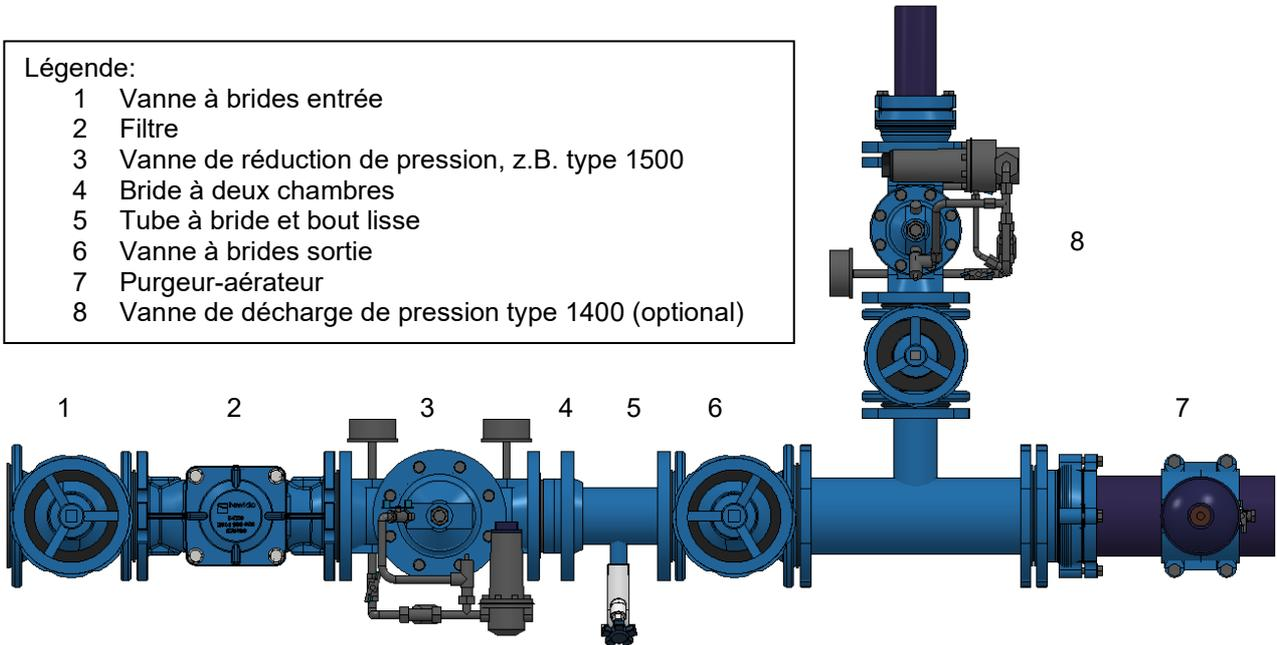
La vanne HAWIDO doit être montée horizontalement (autre mode de montage sur demande), avec le couvercle de vanne vers le haut. Nous recommandons de monter une vanne d'arrêt et un capteur d'impuretés avant la vanne. Avant d'effectuer la mise en service, il faut s'assurer qu'aucun corps étranger important ne puisse pénétrer dans la vanne HAWIDO.
