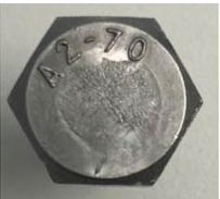
Bei Ventilen mit Baujahr vor 2018, sind möglicherweise Deckelschrauben in der Festigkeitsklasse **A2 –70** verbaut.
