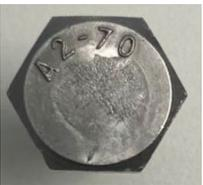
Les vannes fabriquées avant 2018 peuvent avoir des vis de couvercle de classe de résistance A2-70.
