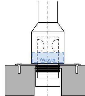
Oben siphoniert im Standrohr von Leer-/Überlauf integriert.
