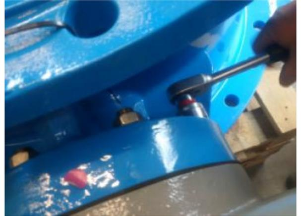
5. Montaggio dell'utensile di estrazione e smontaggio dell'ingranaggio
