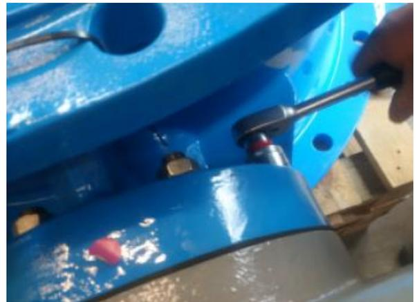
10. Regolare la battuta di finecorsa e la posizione della valvola ruotando la copertura dell'ingranaggio.
