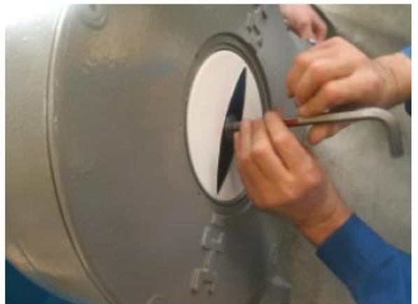
13. Test del funzionamento, verificare il funzionamento dell'indicatore di posizione
