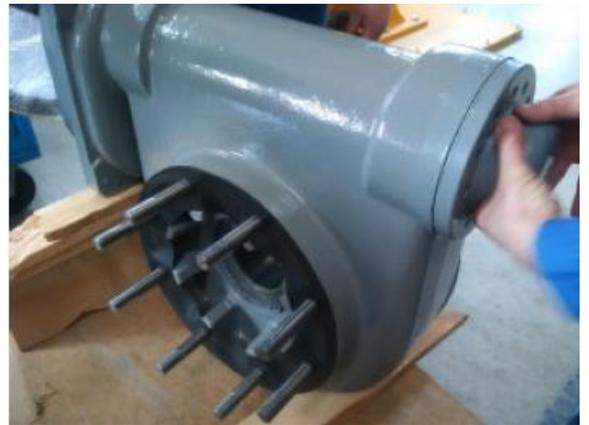
7. Ruotare l'ingranaggio di 90° e rimontarlo
