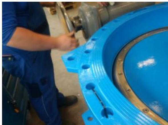
2. Allentare le viti poste sulla copertura inferiore dell'ingranaggio e rimuovere tutte le viti meno una
