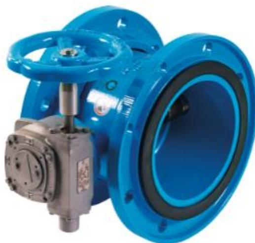
Il rinomato sistema a flange libere con saracinesche intercambiabili è integrato nella valvola a farfalla. Questa valvola a farfalla è pertanto adatta soprattutto per la sostituzione di rubinetteria già esistente. Le flange libere si possono muovere in direzione longitudinale e ruotare di 360°.
