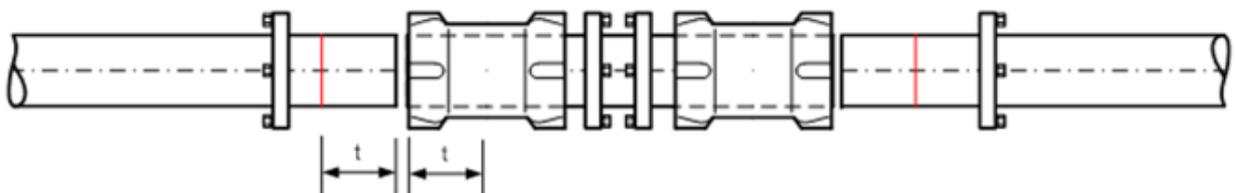
4. Spostare indietro il connettore fino alla profondità d'innesto marcata (attenzione: in caso di sovradimensionamento del tubo già esistente può essere necessario applicare più forza)
