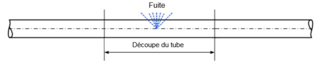
2. Bien chanfreiner le nouveau tronçon de tube PE (10 mm plus court) et les extrémités du tube dans la tranchée. Vérifier le DE du tube existant. (Voir le tableau gén, des dimensions de tubes) Démonter les unités de verrouillage et les glisser sur les extrémités du tube.
