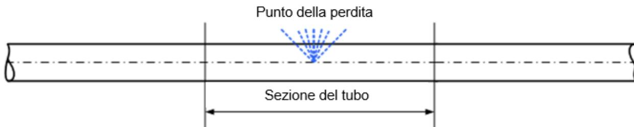
2. Smussare un nuovo pezzo di tubo in PE (10 mm più corto) e le estremità in profondità. Controllare il diametro esterno del tubo già esistente. (v. tabella generale dimensioni tubi) Smontare l'elemento antisfilamento e applicarlo sulle estremità del tubo.
