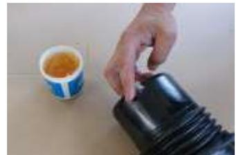
Applicare del lubrificante Hawle sul labbro di tenuta e sull'o-Ring nel manicotto.
