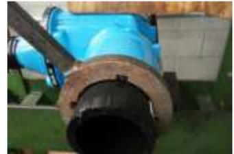
Rimuovere il labbro di tenuta e l'o-Ring, pulirli e controllarli; se necessario, sostituirli.
