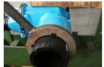
Retirer le joint à lèvres et l'O-Ring, les nettoyer et les contrôler, les remplacer si nécessaire.
