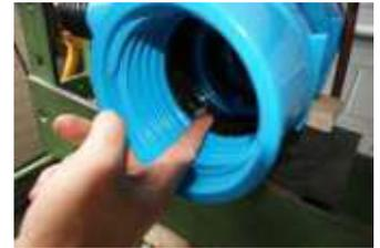
Mettre l'embout à filetage rond dans le manchon avec précaution et serrer dans le sens contraire des aiguilles d'une montre.
