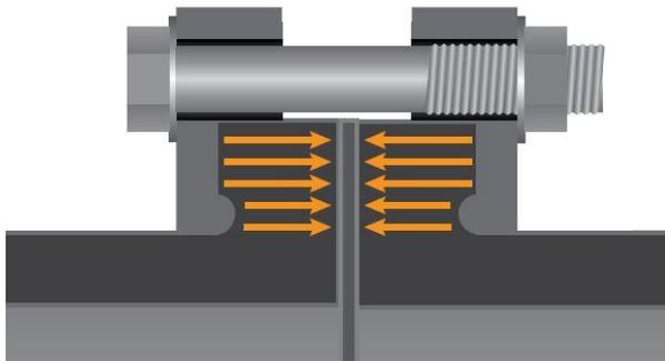
Dank dem patentierten Losflansch, vergrössert der Anpressdruck der Kontaktfläche gegenüber den herkömmlichen Vorschweiss Bund mit Losflansch mit mehr als 50%. Dadurch eignet sich die kunststoffgerechte Konstruktion besonders für höhere Druckstufen wie z.B. PN 25. Weil die Verformung unter Belastung mit diesem Losflansch aktiv entgegen gewirkt wird. Dazu ist die Schweissnaht innen abgedreht.
