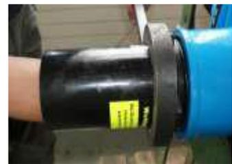
PE-Anschweissende bis zum Anschlag festziehen.
