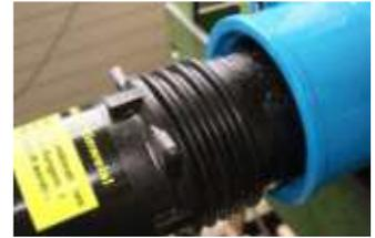
Nach etwa 2 Umdrehungen prüfen, ob die Lippendichtung noch korrekt im Dichtungssitz befindet.
