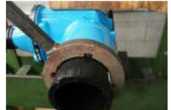
Lippen-Dichtung und O-Ring entfernen, reinigen und prüfen, wenn notwendig ersetzen.
