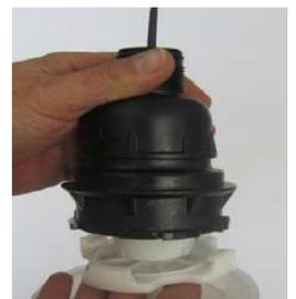
6. Svolgere la membrana rotolante posta sulla vite della sede della valvola e constatare l'eventuale presenza di depositi e danni meccanici. Rimuovere eventuali depositi con un panno umido. Qualora dovesse essere necessario sostituire la membrana, separarla dalla scanalatura e sostituirla con una nuova. Verificare che la membrana sia ben posizionata nella scanalatura.
