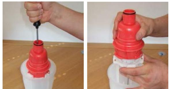
5. Pulire e sciacquare accuratamente l'intaglio della gabbia della valvola. All'occorrenza (in presenza di sporco ostinato o di danni) è possibile smontare la gabbia della valvola dalla testa valvola dopo aver aperto l'anello filettato.
