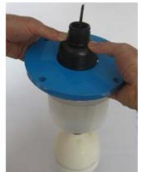
4. Sbloccare la rosetta filtrante premendo i due ganci di sicurezza e staccarla dalla testa del corpo ruotandola verso l'alto e verso sinistra.
