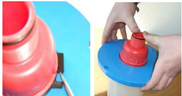
4. Rimuovere il dado cieco SW 13 dall'uscita dell'aria mediante una chiave a bussola (la valvola deve trovarsi nella «posizione di chiuso»).
