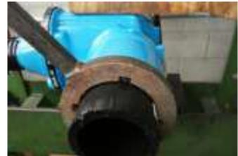
Lippen-Dichtung und O-Ring entfernen, reinigen und prüfen, wenn notwendig ersetzen.
