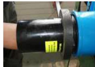
PE-Anschweissende bis zum Anschlag festziehen.
