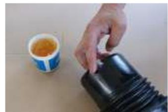
Lippen-Dichtung und O-Ring in der Muffe mit Hawle Gleitmittel einfetten.
