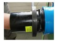
Fare un altro giro e controllare di nuovo. (posizione salda e corretta dell'o-Ring)
