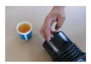
Applicare del lubrificante Hawle sul labbro di tenuta e sull'o-Ring nel manicotto.
