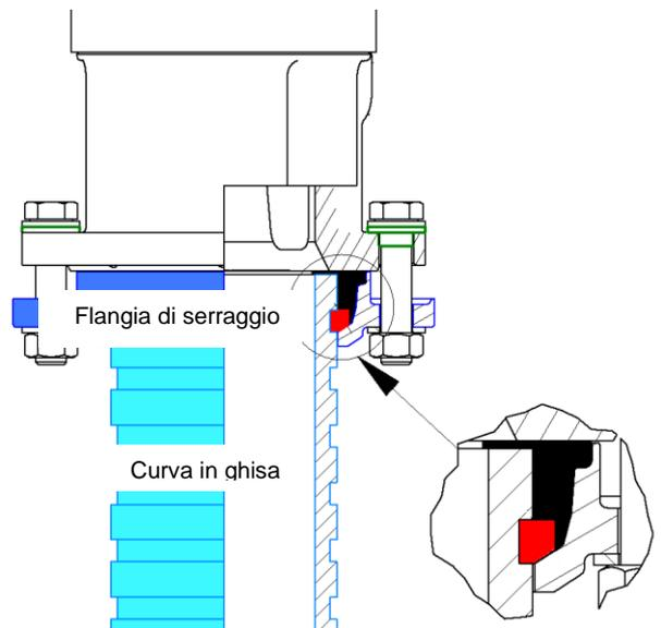
9. Interraggio dell'idrante. Durante questa operazione è necessario proteggere dalle impurità il pietrame di drenaggio. Avvolgere previamente le flange in una benda.
