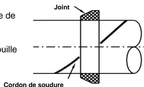
5. Amenez le raccord et les tubes dans la bonne position: ils doivent être séparés d'environ 20 mm.
