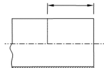
→ En cas de tubes en acier soudés en spirale, les cordons de soudure doivent être lissés dans la zone de la partie du joint.
