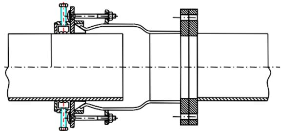
8. Serrer uniformément les vis des éléments d'étanchéité en croix en respectant la mesure «E». La différence entre la plus grande mesure E et la plus petite ne peut pas dépasser 5 mm. Continuez à serrer les vis à l'aide d'une clé dynamométrique. Augmenter le couple de 20 Nm par passage jusqu'à ce que le couple recommandé soit atteint (voir pt. 5.3). Vérifiez après chaque passage que la mesure E (comme décrit ci-dessus) est encore correcte.
