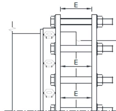
9. Les vis des éléments de verrouillage ne sont pré-serrées à la main jusqu'à ce qu'elles touchent la surface du tube qu'une fois que les vis des éléments d'étanchéité ont été serrées selon les consignes.
