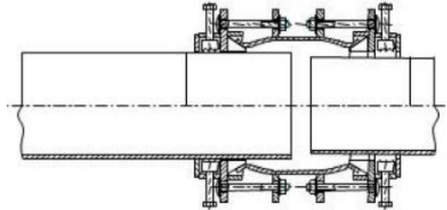
7. Bei der Montage eines Flansch-Übergang Nr. 7210, Flanschverbindung anbringen und festziehen.
