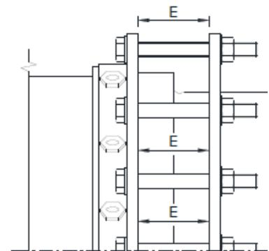
9. Erst nachdem die Schrauben den Dichtungselementen vorschriftsgemäss angezogen wurden, werden die Schrauben für die Schubsicherungselemente von Hand vorgespannt, bis sie die Rohroberfläche berühren.
