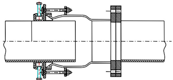
8. Die Schrauben zu den Dichtungselementen übers Kreuz gleichmässig anziehen, dabei das Mass «E» beobachten. Der Unterschied darf von dem grössten zum kleinsten E-Mass, nicht mehr als 5mm betragen. Fahren Sie mit dem Festziehen der Schrauben mit Hilfe eines Drehmoment-Schlüssels fort. Das Drehmoment bei jedem Durchgang um 20 Nm erhöhen, bis das empfohlene Drehmoment erreicht ist (siehe Pt 5.3). Prüfen Sie nach jedem Durchgang, ob das E-Mass (wie oben beschrieben) noch stimmt.
