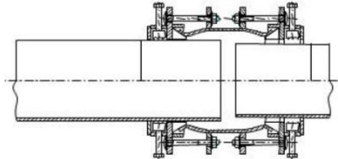
7. Si une transition à bride no 7210 est montée, mettre en place et serrer le raccord à bride.
