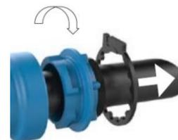
**Attention:** si la pièce de transition est utilisée plusieurs fois, il faut remplacer le crampon et éventuellement aussi l'Joint ou la bague d'étanchéité.
