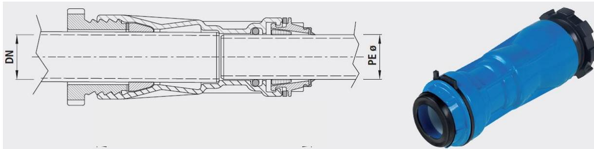
La pièce de transition de Hawle est idéale pour relier des tubes en fonte et des tubes en PE dans la construction de conduites d'eau. D'une part avec un manchon à vis, ne résiste pas aux contraintes longitudinales, d'autre part avec un manchon à emboîtement en PE et une douille conique démontable pour le raccordement avec verrouillage de tubes PE. La pièce de transition peut chaque fois se glisser sur le petit tube (diamètre extérieur).
