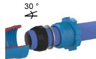
Bei Bedarf muss zusätzlich eine Schubsicherung auf der Gusseite montiert werden!
