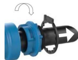
**Achtung:** Bei Mehrfachverwendung des Übergangsstückes sind Klemme und gegebenenfalls auch der O-Ring bzw. der Dichtungsring auszutauschen.
