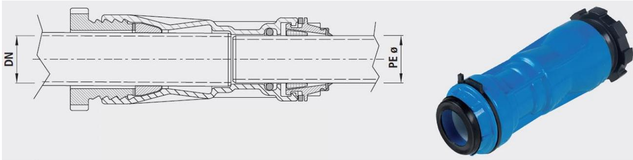
Das Übergangsstück von Hawle ist der optimaler Verbinder für Guss- auf PE-Rohre im Wasserleitungsbau. Einerseits mit Schraubmuffe für Gussrohre, nicht längskraftschlüssig, andererseits mit PE-Steckmuffe und demontierbarem Konusring für die schubsichere Verbindung von PE-Rohren. Das Übergangsstück ist jeweils über das kleinere Rohr (Aussendurchmesser) überschiebbar.
