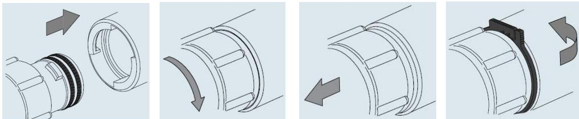
Schutzverpackung und Abdeckungen des Fittings entfernen.
