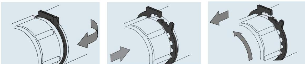
1. Verzahnung des Schubsicherungsringes öffnen und vorsichtig aufweiten und entfernen.
