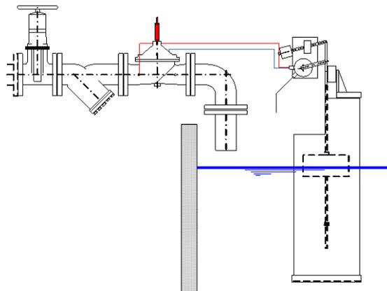
Dans le cas d'une pression amont entre 1.5 à 4 bar, la vanne Hawido type 1600 peut installer avec un limiteur d'ouverture.
