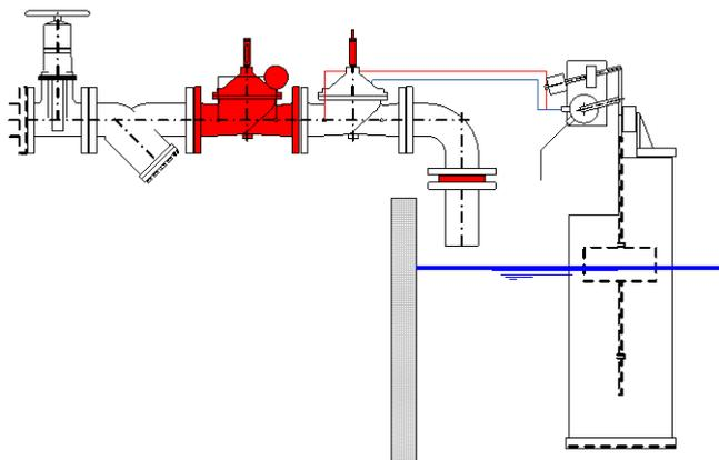
Dans le cas d'une pression amont entre 9 à 16 bar, la vanne Hawido type 1600 doit installer avec un limiteur d'ouverture, une vanne de réduction de pression type 1500 et une diaphragme.
