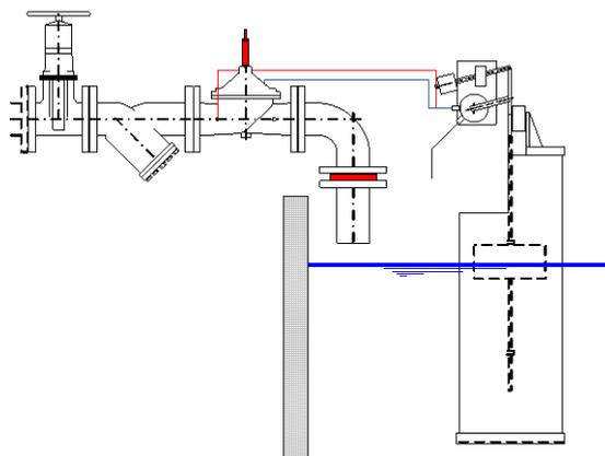
Dans le cas d'une pression amont entre 4 à 9 bar, la vanne Hawido type 1600 doit installer avec un limiteur d'ouverture et une diaphragme.
