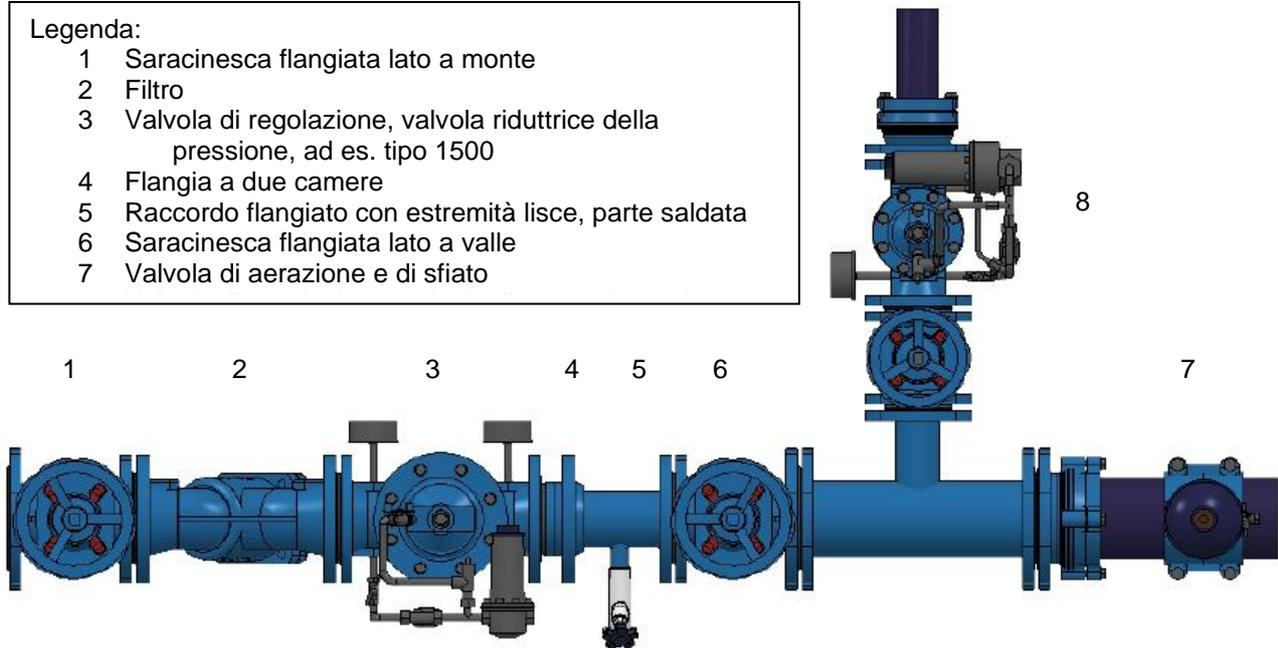
La valvola HAWIDO deve essere installata orizzontalmente (altri tipi di montaggio su richiesta) con il coperchio rivolto verso l'alto. Consigliamo di montare una saracinesca di chiusura ed un filtro a monte della valvola ed una saracinesca di chiusura a valle.
