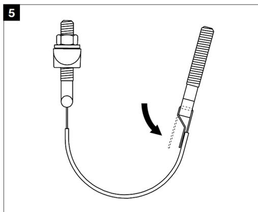
5 Überstehendes Bügelblechende bis zur Blechinnenseite zusammenbiegen. Achtung: Aus Korrosionsschutzgründen bitte einen Kunststoffhammer verwenden! Keinen Hammer oder Zangen aus Stahl verwenden!
