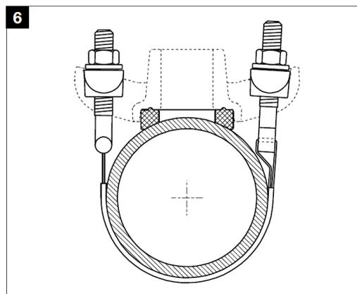
6 Bügel einseitig am Schellenkörper einhängen und um das Rohr biegen. Zweite Klemmbacke montieren. Sechskantschrauben mit angegebenem Dreh-moment (60 - 70 Nm / max. 100 Nm) festziehen. Keine Verlängerung verwenden! Dichtheitsprüfung durchführen
