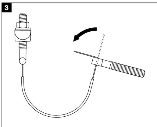
3 Bügel und Montage-T-Stück miteinander fixieren. Überstehendes Bügelblechende an der gekennzeichneten Position 90° zur Rohrseite entlang des Montage-T-Stückes umbiegen
