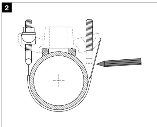
2 Bügel montieren, am Schellenkörper einhängen und um das Rohr biegen. Montage-T-Stück anlegen. Kennzeichnen der Biegeposition am Blechstreifen und der Markierung zum Ablängen (Biegeposition + min. 100 mm). Bügelblech und Auflagegummi kürzen!
