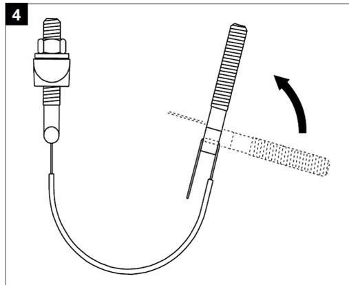
4 Bügelblech und Montage-T-Stück weiter um 90° nach links biegen.
