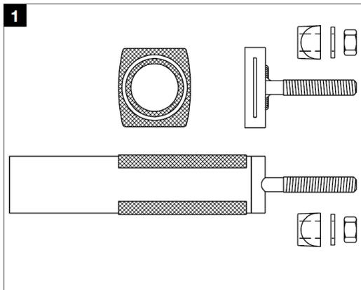
1 Prüfen der Vollständigkeit der Bügeleinzelteile. Klemmbacken, Satteldichtungen, Montage-T-Stück, Sechskantmuttern, Klemmbacken, Unterlegscheiben. Zum Außendurchmesser der Rohrleitung passende Satteldichtung auswählen!
