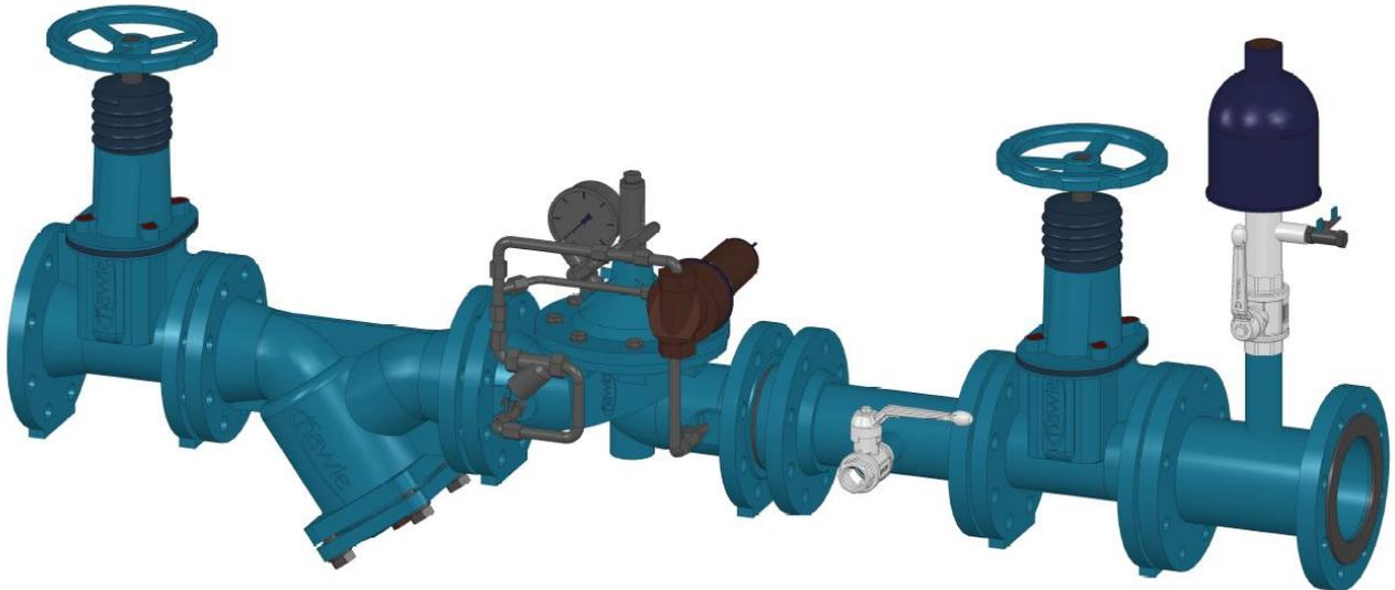
La vanne HAWIDO doit être montée horizontalement (autre mode de montage sur demande), avec le couvercle de vanne vers le haut. Nous recommandons de monter une vanne d'arrêt et un capteur d'impuretés avant la vanne. Avant d'effectuer la mise en service, il faut s'assurer qu'aucun corps étranger important ne puisse pénétrer dans la vanne HAWIDO.
