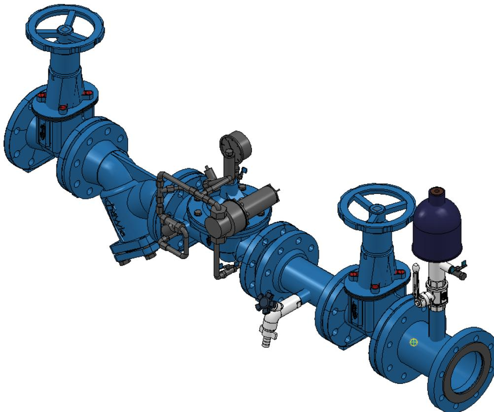
La valvola HAWIDO deve essere installata orizzontalmente (altri tipi di montaggio su richiesta) con il coperchio rivolto verso l'alto. Consigliamo di montare una saracinesca di chiusura ed un filtro a monte della valvola ed una saracinesca di chiusura a valle.
