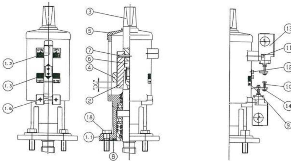
N° 1.1 Indicateur de position (boîtier) n° 8. Joint plat
