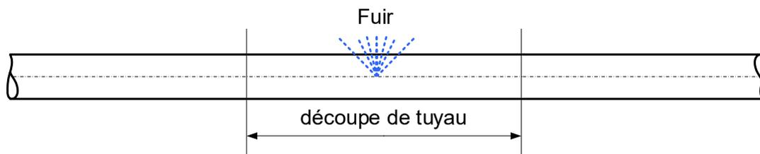
2. Biseutez la nouvelle section de tuyau PE (10 mm plus courte) et les extrémités du tuyau bien dans la tranchée. Vérifiez l'AD sur le tuyau existant. (voir tableau général des dimensions des tubes) Démontez les unités de résistance à la poussée et faites-les glisser sur les extrémités des tubes.
