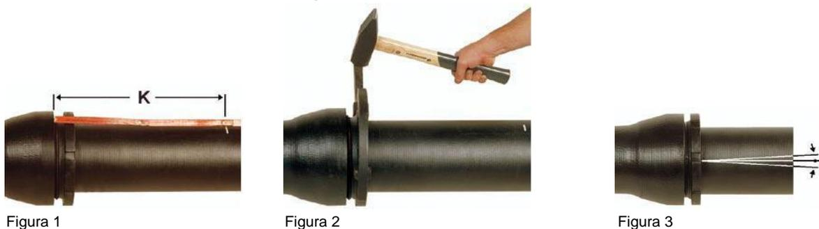
**Indicazione sulla deviazione:** il collegamento con manicotti a vite può essere deviato immediatamente dopo il serraggio dell'anello filettato. L'angolo di deviazione massimo ammesso è di 3°. (v. Figura 3)
