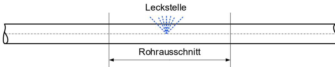
2. Smussare la nuova sezione del tubo in PE (10 mm più corta) e far sì che il tubo finisca bene nella trincea. Controllare AD sulla tubazione esistente. (vedere la tabella delle dimensioni generali dei tubi) Smontare le unità di resistenza alla spinta e farle scorrere sulle estremità dei tubi.
