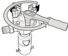
1: Relâcher la pression à l'aide des robinets de contrôle installés sur le disconnecteur. Ouvrir le couvercle.
