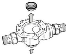
3: Extraire soigneusement le siège de la vanne de vidange depuis l'extérieur en exerçant une légère pression pour ne pas l'endommager. **Attention:** si le siège de la vanne n'est pas retiré, il faut veiller lors du démontage du clapet anti-retour à ce qu'il ne soit pas endommagé par des coups.
