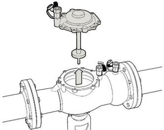
3: Extraire soigneusement le siège de la vanne de vidange depuis l'extérieur en exerçant une légère pression pour ne pas l'endommager.
