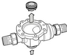
3: Durch leichten Druck von aussen den Ventilsitz des Ablassventils vorsichtig, so dass dieser nicht beschädigt wird, herausdrücken.
