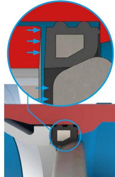
Sitzdichtung wird durch den Betriebsdruck gegen die Klappenscheibe gedrückt.
