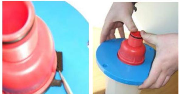
4. Hutmutter SW 13 im Luftaustritt mittels Steckschlüssel entfernen (Ventil muss dabei in „Geschlossen-Stellung“ sein).
