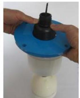
4. Siebscheibe durch eindrücken der beiden Sicherungshaken entriegeln und durch Linksdrehung vom Gehäusekopf nach oben abziehen.
