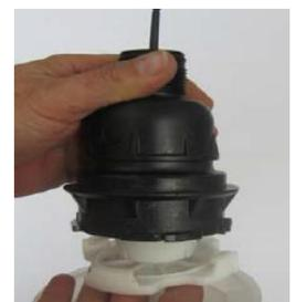
6. Rollmembrane an der Schraube aus dem Ventilkörper heraus stülpen und auf Ablagerungen und mechanische Beschädigungen prüfen. Ablagerungen durch Abwischen mit feuchtem Tuch entfernen. Sollte ein Tausch der Membrane erforderlich sein, Membrane aus Haltenut trennen und durch neue ersetzen. Korrekten Sitz der Membrane in der Nut überprüfen.
