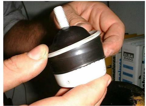
8. Membrane durch zurückziehen bis zu der geformten Wulst zentrieren und in den Ventilköcher stülpen.
