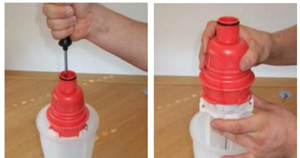
5. Schlitze des Ventilkorbes reinigen und durchspülen. Bei Bedarf (besonders starke Verschmutzung oder Beschädigung) kann der Ventilkorb, nach dem Öffnen des Schraubringes mittels Stiftschlüssel, aus dem Ventilkopf ausgebaut werden.
