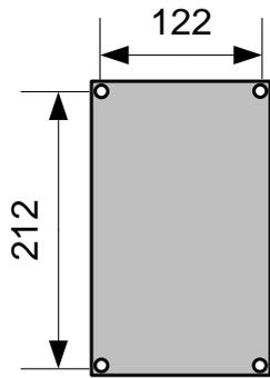
Ces dimensions sont également visibles au dos du boîtier de commande.
