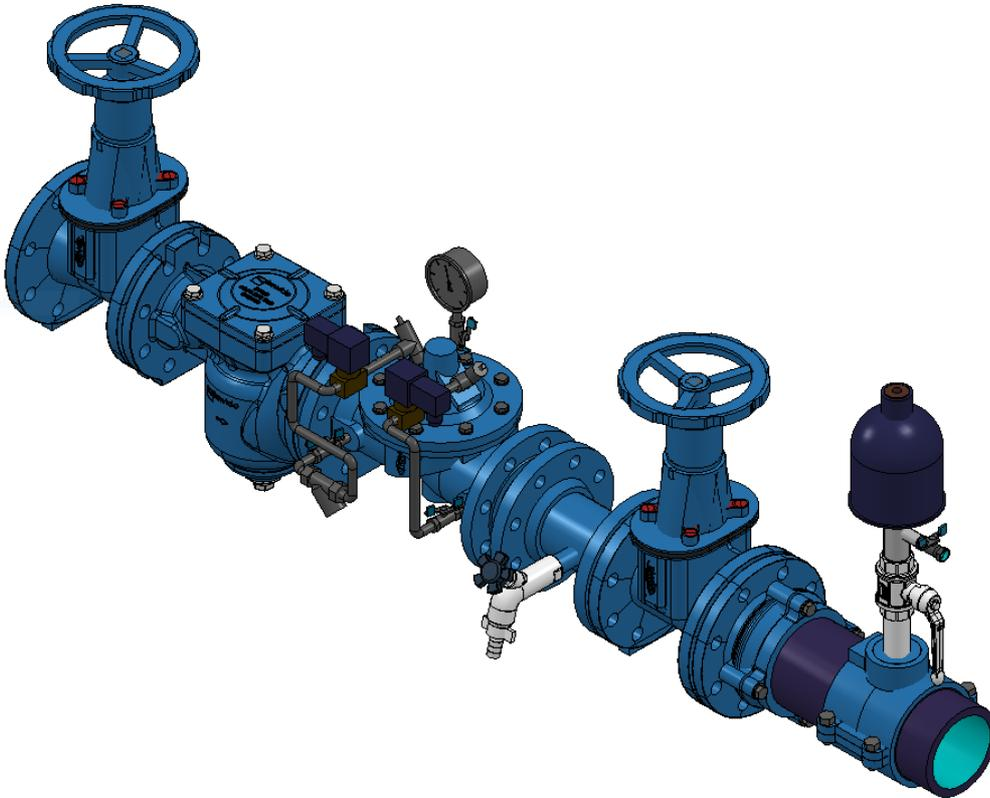
La vanne HAWIDO doit être montée horizontalement (autre mode de montage sur demande), avec le couvercle de vanne vers le haut. Nous recommandons de monter une vanne d'arrêt et un capteur d'impuretés avant la vanne. Avant d'effectuer la mise en service, il faut s'assurer qu'aucun corps étranger important ne puisse pénétrer dans la vanne HAWIDO.
